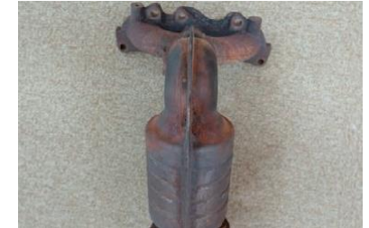
Colector de escape agrietado de Honda Life mini-vehículo fabricado en 1999
