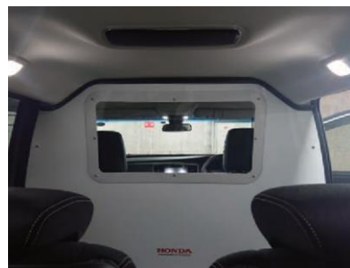
Interior de un vehículo utilizado para transportar el blindaje facial COVID-19 producido por pacientes de Honda (con una barrera de plástico entre el conductor y asientos traseros )
