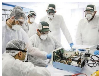
Reparación del ventilador
